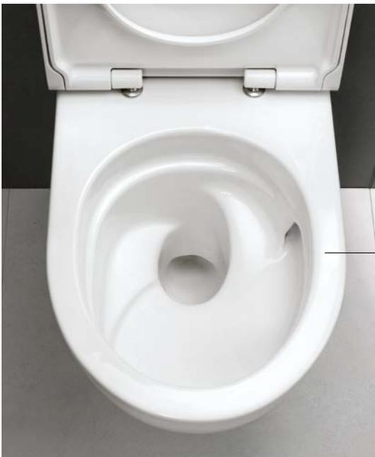
Die innovative TurboFlush-Spülung versetzt das Wasser durch eine seitliche Spülöffnung und die asymmetrisch gestaltete Keramik in eine spiralförmige Bewegung. Das Ergebnis: außergewöhnlich saubere und leise Ausspülung bei geringem Wasserverbrauch.
